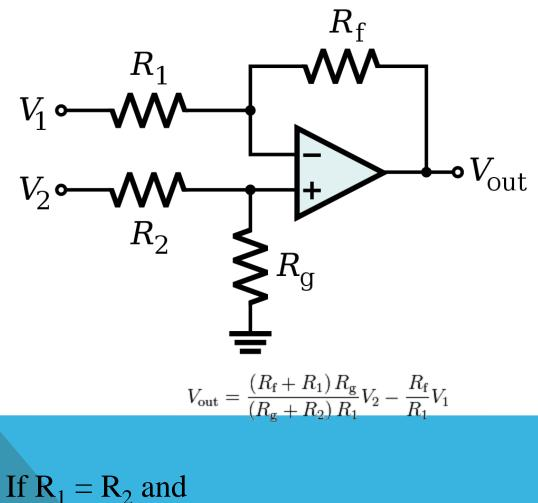
$V_{\text{out}} = \frac{R_{\text{f}}}{R_1} (V_2 - V_1)$
